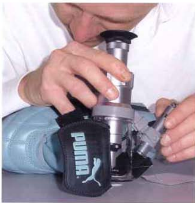
Ein einfaches Stabmikroskop genügt, um die Farbcodes zu identifizieren. Es sind keine teuren Lesegeräte erforderlich.
