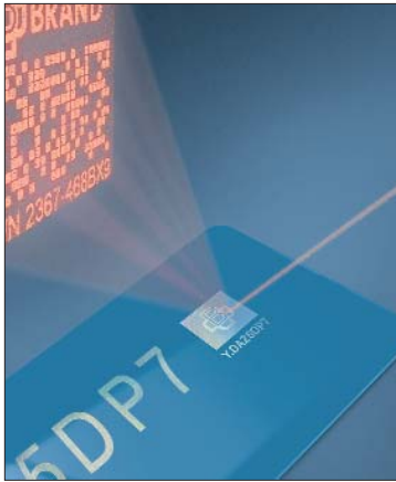
I Bild 3. Die Holospot-Etiketten von Tesa-Scribos messen 5 \times 10 \text{ mm}^2 und werden mittels Laserbeschriftung zu einem Unikat. Die eingebrannte Information kann sowohl mit bloßem Auge sichtbar als auch maschinenlesbar sein.
