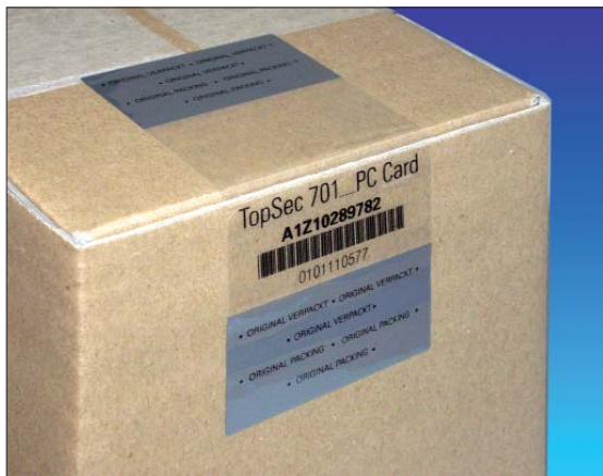
! Bild 5. Das mehrlagige Dry-Peel-Siegel verliert beim Abziehen seine Klebkraft. Mit einer zwischen den Lagen verborgenen Sicherheitsnummer, die beim Öffnen freigelegt wird, kann das Produkt auf Echtheit überprüft werden.
