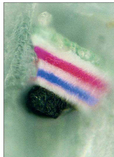
! Bild 6. Secutag-Farbpartikel unter dem Mikroskop. Die Partikel können auf feste Oberflächen aufgebracht oder Pulvern und Flüssigkeiten beigegeben werden.
